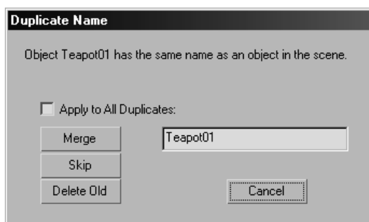
Rysunek 1.41. Jeżeli nazwy obiektów powtarzają się, program sugeruje scalenie obiektów oraz/lub usunięcie obiektu pierwotnego
